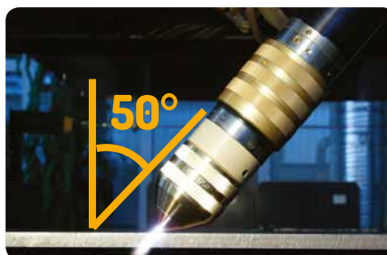
Fasenschneiden bis 50° | Bevel cutting up to 50°
