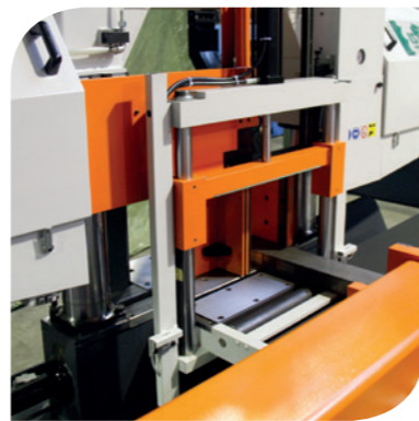
Morsa verticale (optional) per il taglio a fascio Nesting fixture (optional) tu cut bundles
